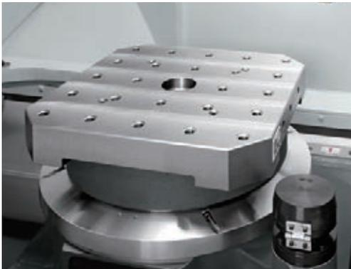
Eine Rundachse mit 1° Grad Schaltung ist Standard und ein vollwertiger Rundtisch, ausgestattet mit DDM, steht als Option zur Verfügung. Diese Leistungsmerkmale haben bedeutende Vorteile für die Bearbeitung von Werkstücken, die eine hohe Geschwindigkeit und eine große Positioniergenauigkeit erfordern.
