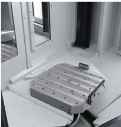
Einsatz eines 2 Stationen Palettenwechslers an der Vorderseite. Der schnelle Palettenwechsel (APW) reduziert die Nebenzeiten.
